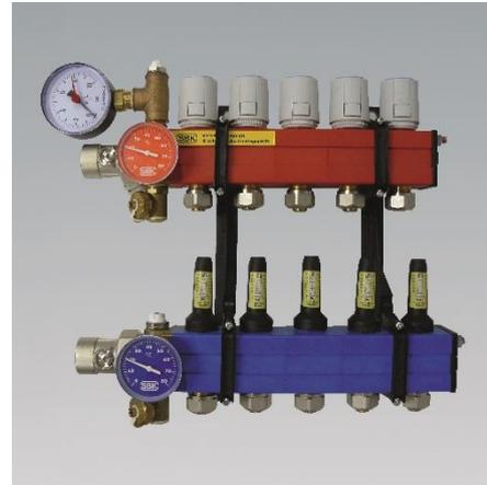
Für den hydraulischen Abgleich der Heizkreise und die damit erreichbare zielgerichtete Versorgung aller angeschlossenen Mattenfelder, sorgen die einstellbaren Ventilspindeln in den Rücklaufmodulen.
